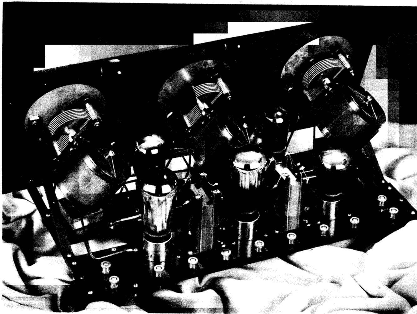
figura 5 bis - Vista del telaio. Notare le bobine inclinate.
